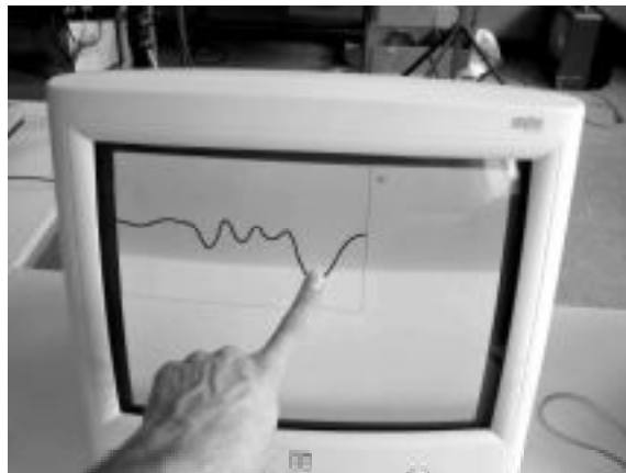
Figure 6 : Manipulation de la corde virtuelle de l'algorithme de synthèse par balayage à l'aide d'un écran tactile. Le principe de l'interaction est le suivant : Lorsque le doigt rencontre la corde, le programme agit de façon à ce que la corde ne traverse pas le doigt mais suive ses mouvements. Quand un doigt est posé sur l'écran, le programme détermine s'il est posé au-dessus ou au-dessous de la corde. En fonction de l'endroit où l'on a placé initialement son doigt, il faut appuyer sur la corde (en déplaçant le doigt vers le bas) ou la soulever (en déplaçant le doigt vers le haut) pour interagir avec elle.
